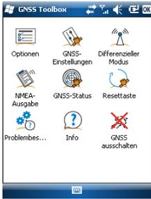
**GNSS Toolbox** dient zum Steuern und Überwachen wichtiger Empfängerfunktionen. Diese werden unten genauer erklärt.
