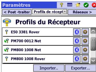
Plus tard, lorsque vous démarrerez un levé, sélectionner simplement le profil de récepteur de votre choix (et un *profil réseau* si vous travaillez dans un réseau ; voir également *Gérer les profils réseau en page 34*) avant de demander à Survey Pro de se connecter au récepteur que vous utilisez. Survey Pro configurera le récepteur selon les paramètres définis dans le profil de récepteur sélectionné.
