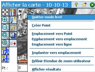
Si Optique ou GNSS est sélectionné, la carte principale peut également servir d'interface pour la collecte de mesures. Taper sur la carte principale, maintenir la sélection, puis choisir **Mode levé** pour activer l'interface de mesure (voir l'exemple ci-contre pour GNSS).
