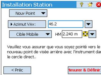
NOTE : Si l'instrument utilisé est incapable de définir le cercle de visée arrière, le bouton se nomme "**Mesurer & Lire**", et non pas "**Mesurer & Définir**".
