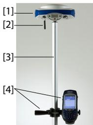
Le ProMark 500 inclut dans sa version standard un modem GSM intégré, ce qui signifie que vous n'avez plus qu'à connecter l'antenne GSM si vous avez déjà payé pour l'activation du modem. Montez les différents éléments comme indiqué sur la photo, incluant le ProMark 500 [1], l'antenne GSM [2], la canne [3] et le carnet de terrain avec son support de fixation [4].
