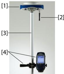
Montez les différents éléments comme indiqué sur la photo, incluant le ProMark 500 [1], l'antenne radio [2], la canne [3] et le carnet de terrain avec son support de fixation [4].
