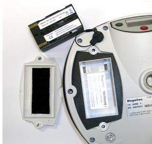
La batterie du ProMark 500 est une batterie rechargeable de 7,4 V DC - 4 400 mAh. C'est un modèle standard que l'on trouve dans de nombreux caméscopes.
