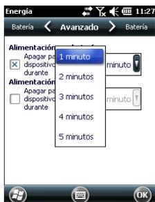
Una forma mejor de ahorrar batería es dejar que el receptor pase a modo de suspensión automáticamente al cabo de un cierto periodo de inactividad.
