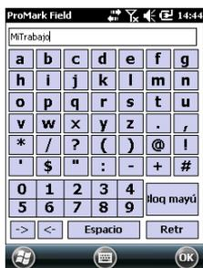
ProMark Field integra un gran teclado virtual que facilita la entrada de datos en campo. Al activarse, este teclado aparece automáticamente en pantalla cada vez que se toca un campo de datos editable por el usuario.
