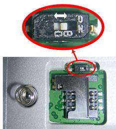
Über einen Schiebeschalter unten im Akkufach bestimmen Sie, was bei Entfeiern oder Ausfall der Stromversorgung geschehen soll:
