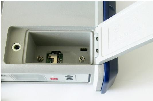
Im Gerät kommt ein wiederaufladbarer Akku mit 7,4 V DC und 4.600 mAh zum Einsatz. Dieses Modell wird auch in vielen Camcordern verwendet.
