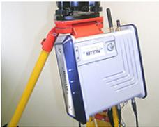
In Vermessungsanwendungen kann der ProFlex 500 als transportable Basis an einem Stativbein befestigt werden. Dazu verfügt er über eine Lasche an der Geräteunterseite. Die Lasche kann auf zwei Arten am Gehäuse angebracht werden, sodass der Empfänger mit der Front nach oben oder zur Seite (empfohlen) befestigt werden kann.
