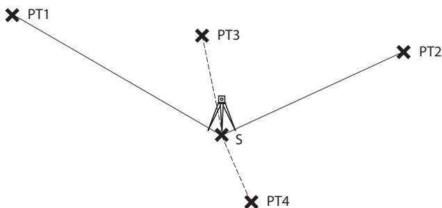
Точка S, где установлена станция, является известной точкой. Следует измерить не менее одной известной точки, чтобы определить ориентацию инструмента и соответственно скорректировать ее. Другие известные точки (PT3, PT4...) можно добавить для более точного вычисления угла коррекции.
