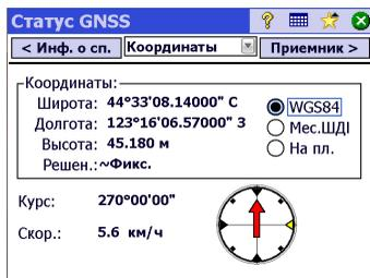
Прежде чем продолжить работу, вам нужно убедиться в том, что принимаются и используются не менее 6 спутников, и каждый спутник обеспечивает хороший уровень сигнала, а приемник обеспечивает решение положения в 3D.
