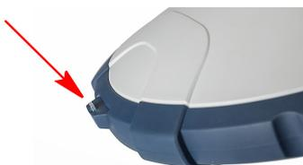
Si el receptor se monta sobre un trípode (p. ej., para su uso como base), realizar una medida en línea recta para determinar la altura del instrumento a menudo es más cómodo que realizar una medida vertical desde la marca de suelo hasta la base de la antena.
