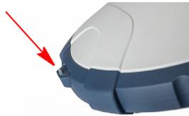
Lorsque le récepteur est monté sur un trépied – en utilisation base par exemple – il est souvent plus pratique d'effectuer une mesure oblique plutôt qu'une mesure verticale, pour déterminer la hauteur d'instrument (distance entre le repère au sol et la base de l'antenne).
