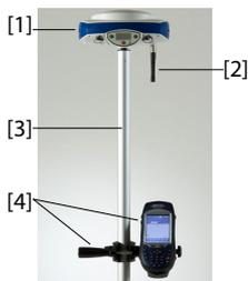
Monte los distintos elementos tal como se indica en la imagen, incluido el ProMark 500 [1], la antena de radio [2], el poste extensible [3] y el terminal de campo con su soporte de montaje [4].
