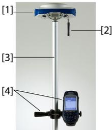
Verbinden Sie die einzelnen Komponenten miteinander. Sie benötigen den ProMark 500 [1], die Funkantenne [2], den Prismenstab [3] und den Feldrechner mit Halterung [4].
