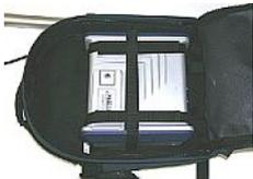
El ProFlex 500 se aloja en una mochila al utilizarlo como receptor remoto para aplicaciones topográficas. La sujeción del receptor mediante la mochila se describe detalladamente en *Preparación del receptor RTK remoto en la página 26.*
