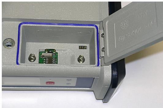
La batería empleada es una batería recargable de 7,4 VCC – 4.400 mAh. Se trata de un modelo estándar empleado en muchas cámaras de vídeo.
