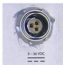
Un conector hembra Fischer de tres contactos[1] que permite alimentar el ProFlex 500 mediante el adaptador de CA proporcionado (conecte la extensión de cable entre el ProFlex 500 y el extremo del cable de salida del adaptador de CA), o una fuente de alimentación externa de 9 a 36 VCC mediante el cable P/N 730477 (cf. configuración de la base con un transmisor de radio externo).
