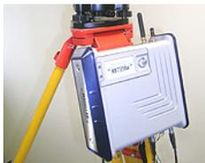
En aplicaciones topográficas, al utilizarse como base itinerante montada sobre un trípode, el ProFlex 500 se puede colocar sobre una de las patas del trípode, mediante el tornillo situado en su parte inferior.
