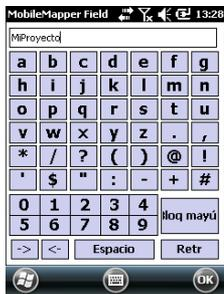
MobileMapper Field integra un gran teclado virtual que facilita la entrada de datos en campo. Al activarse, este teclado aparece automáticamente en pantalla cada vez que se toca un campo de datos editable por el usuario.
